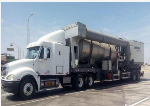
*Transportando Planta de Asfalto*
